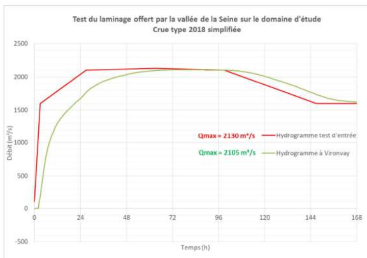
Figure 34 : Test de sensibilité à l'écèlement de la crue de février 2018
